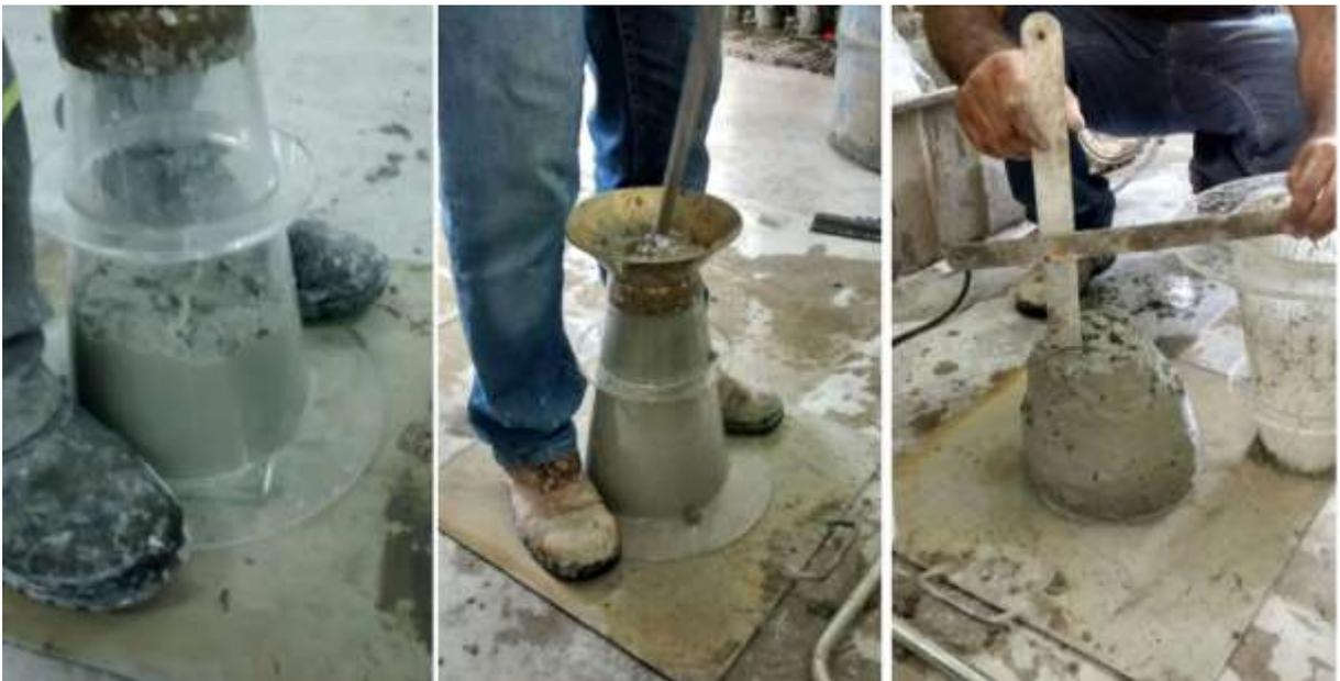
Figura 25: Ensaio de consistência pelo método de Slump
