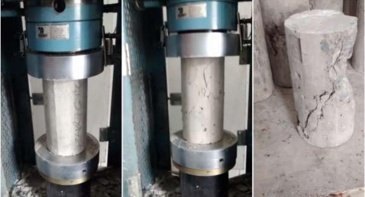
Figura 26: ensaios de resistência à compressão simples
