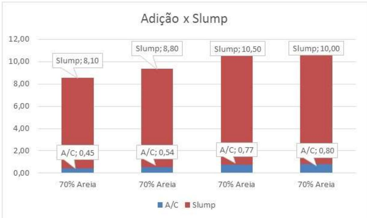
Figura 38: Trabalhabilidade em função da adição - Dosagem D
