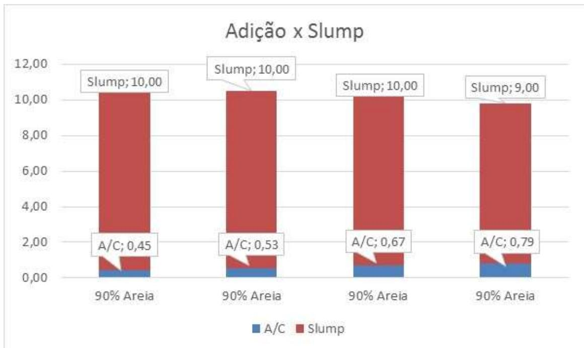
**Figura 32: Trabalhabilidade em função da adição - Dosagem B**
