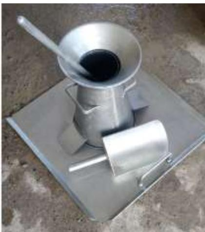
**Figura 14: Conjunto de Slump Test (fonte: própria)**
