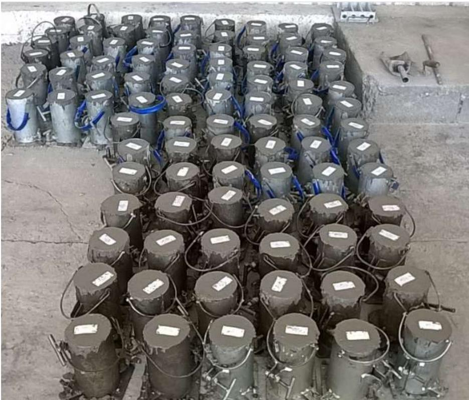
Figura 24: Modalgem dos corpos de prova como descrito pela NBR 5738;
