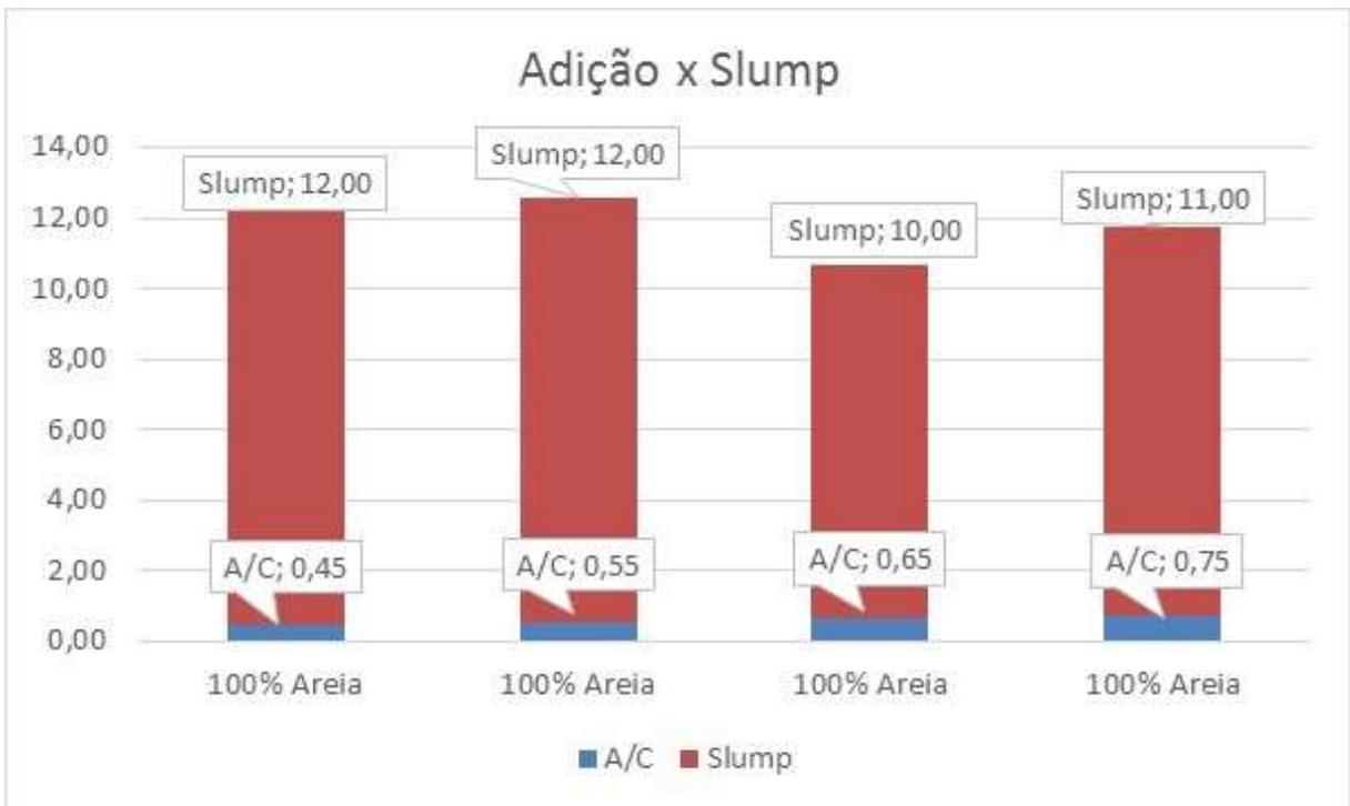
Figura 29: Trabalhabilidade em função da adição - Dosagem A
