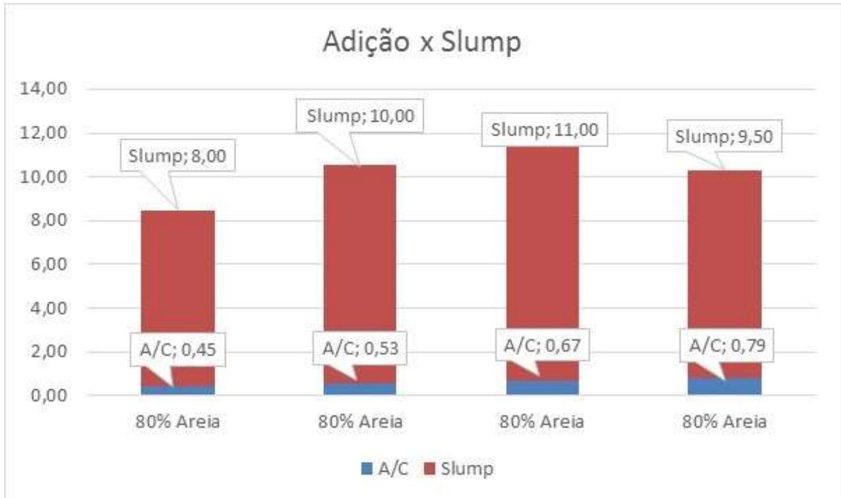
Figura 35: Trabalhabilidade em função da adição - Dosagem C
