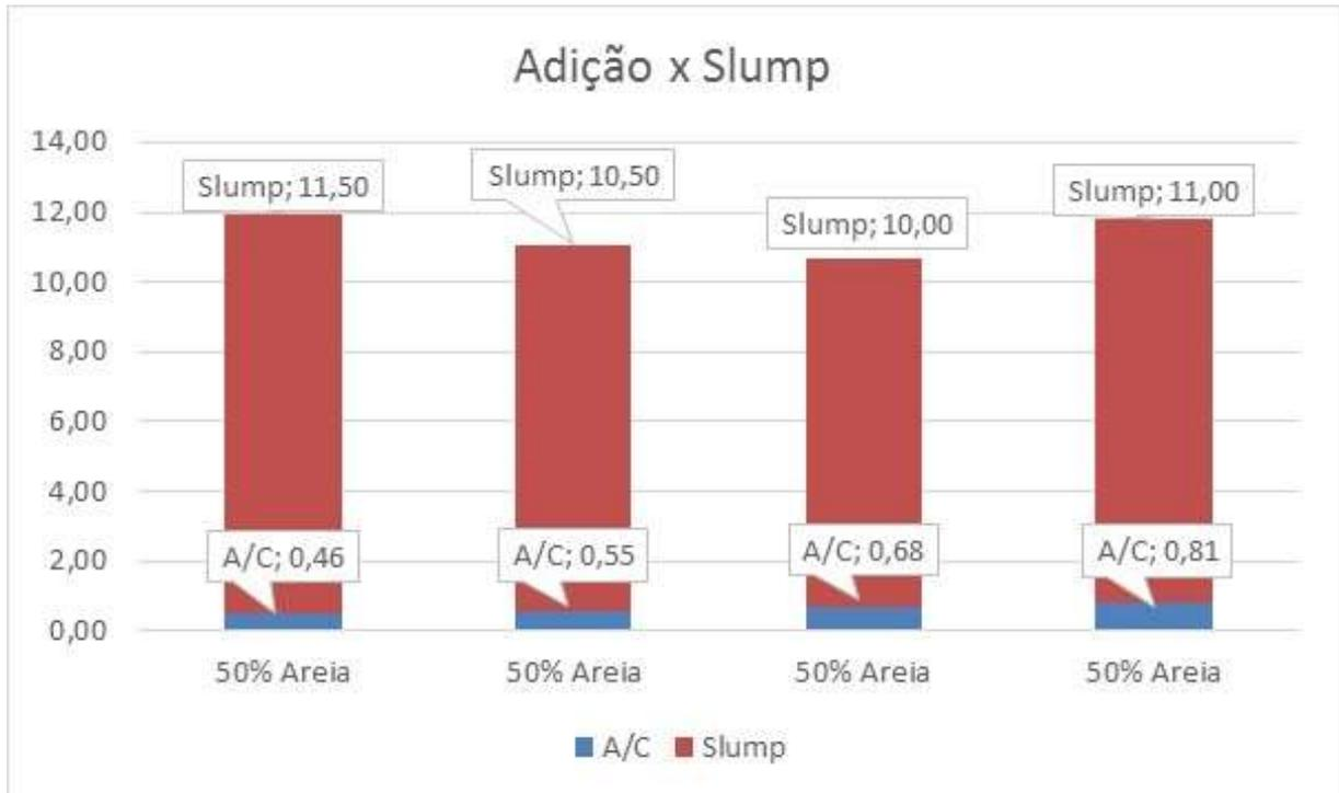
**Figura 44: Trabalhabilidade em função da adição - Dosagem F**
